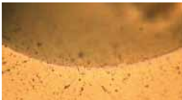
Superficie tratada con PorEx® tras el test Rockwell. Grado de potencia adhesiva HF1, 400x
