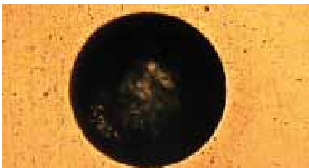
Superficie tratada con PorEx® tras el test Rockwell. Grado de potencia adhesiva HF1, 100x
